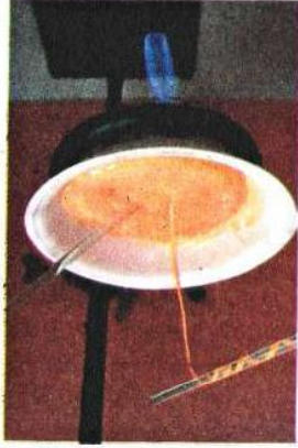
Рис. 74. Витягування нитки з розплавленої смоли капрону
