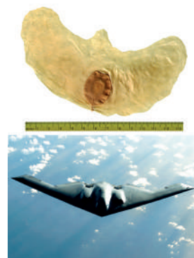
Ил. 2. Насінина занонії, що слугувала зразком під час створення апаратів типу «літаюче крило»
