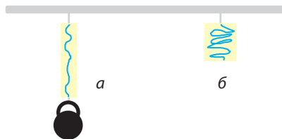
Мал. 32.4. За умови дії навантаження на еластичні полімери їхні макромолекули розпрямляються (а) та оборотно скручуються після його зняття (б)
