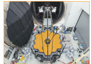
Рис. 3.2 Сегментоване дзеркало новітнього космічного телескопа «Джеймс Уебб»
