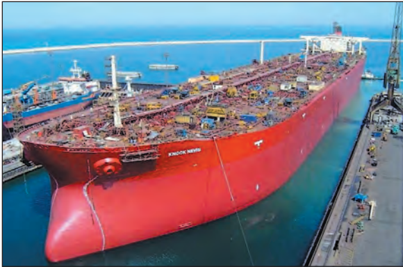
Мал. 4. Японський супертанкер «Кнок Невіс», що понад три десятиліття був найбільшим судном світу. Це морське самохідне судно завдовжки 458 м було здатне перевозити понад 560 тис. т нафти. У 2010 р. танкер було утилізовано у зв'язку із завершенням терміну експлуатації.
