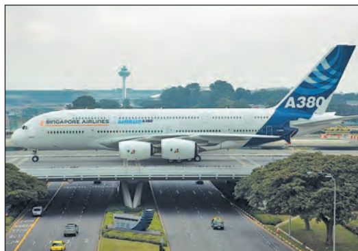
Мал. 3. Двопалубний реактивний пасажирський літак «Ербас А380» — найбільший серійний авіалайнер у світі (висота — 24,08 м, довжина — 72,75 м, розмах крила — 79,75 м).
