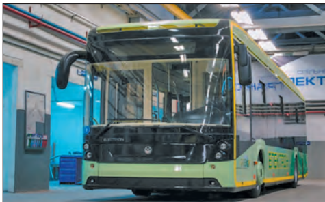
Мал. 4. Електроавтобус виробництва підприємства «Електронтранс». Електричні двигуни безшумні, надійні, не дають шкідливих викидів, мають великий коефіцієнт корисної дії, але автобус повинен мати своє джерело енергії — акумуляторну батарею, яку потрібно заряджати.
