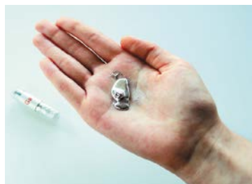
Мал. 31.4. Температура плавлення галію така низька, що він плавиться від теплоти людського тіла
