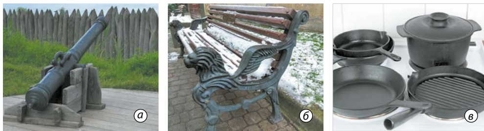
Мал. 36.7. Вироби з чавуну: а — козацька пушка (о. Хортиця); б — лави (м. Львів); в — посуд
