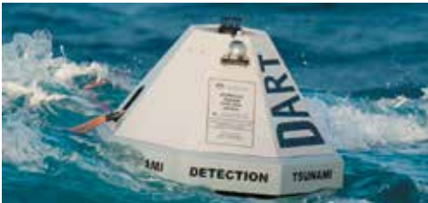
Поверхневий буй для попередження про цунамі
