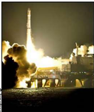
Рис. 5. Космодром в Океані. Ідея морського космодрому полягає в тому, щоб доставляти ракету-носії морем на екватор, де умови для запуску оптимальніші завдяки можливості використовувати інерцію обертання Землі.
