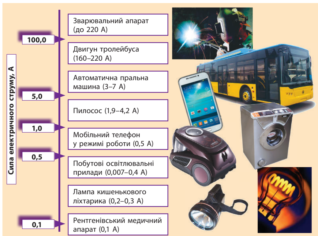
Рис. 27.4. Значення сили струму в деяких електротехнічних пристроях
