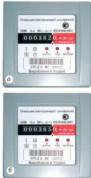
Рис. 33.1. Зняття показів лічильника: а — початкові дані (382 кВт·год); б — дані лічильника після деякого часу роботи електрообігрівача (385 кВт·год). Кількість використаної за цей час електроенергії: 385 - 382 = 3 (кВт·год)
