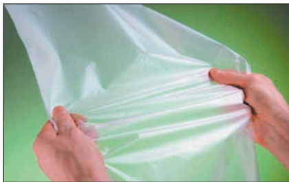
Мал. 6. Поліетилен — досить міцний матеріал. Плівку з нього можна згинати, м'яти, але важко порвати. Поліетилен не проводить електричний струм. Він є стійким до впливу кислот, лугів. Окремі різновиди поліетилену застосовуються у виробництві бронешитів і навіть броньованих автомобілів.
