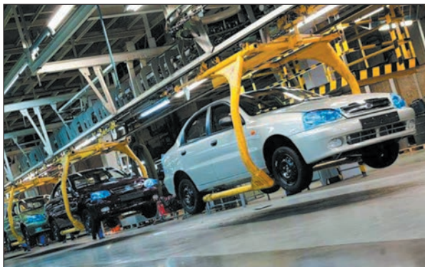
Мал. 1. Конвеєр Запорізького автомобільного заводу. Масове виробництво машинобудівної продукції має значні переваги над одиничним. Воно передбачає тісні зв'язки з підприємствами, що постачають окремі деталі та вузли.
