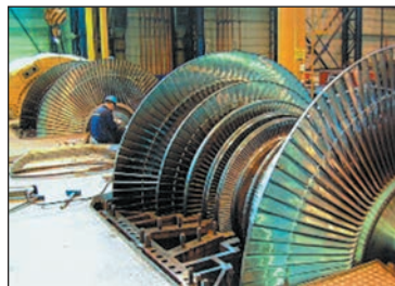
Мал. 2. Харківський турбінний завод (ПАТ «Турбоатом») — одне з найбільших у світі турбобудівних підприємств. Він має вузьку спеціалізацію і виробляє турбіни для теплових, атомних, гідро- та електростанцій, теплоелектроцентралей.
