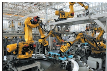
Мал. 2. Промислові роботи в цеху автомобільної компанії «Ніссан» (Японія). Більшість роботів використовують для зварювання, фарбування, установки дрібних деталей, проведення вантажно-розвантажувальних робіт. Найпотужніший робот здатен підняти вантажі до 1350 кг на висоту до 6 м.
