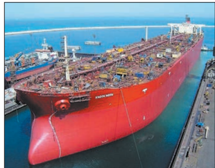
Мал. 5. Японський супертанкер «Кнок Невіс» понад три десятиліття був найбільшим судном світу. Довжина супертанкера становить 458 м, а ширина — 69 м (за розмірами це п'ять футбольних полів). Він здатний перевозити понад півмільйона тонн нафти.
