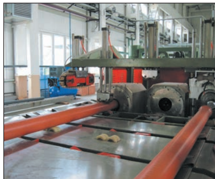
Мал. 5. Калуський трубний завод. Із 2009 р. в Калуші працює підприємство, яке виробляє пластикові труби для водопостачання, каналізації. Такі труби не піддаються корозії, не потребують фарбування, добре гнуться, мають спрощений процес з'єднання. Основними чинниками вибору місця розташування заводу стали близькість до постачальника сировини (підприємство «Карпатнафтохім») та наявність споживача.
