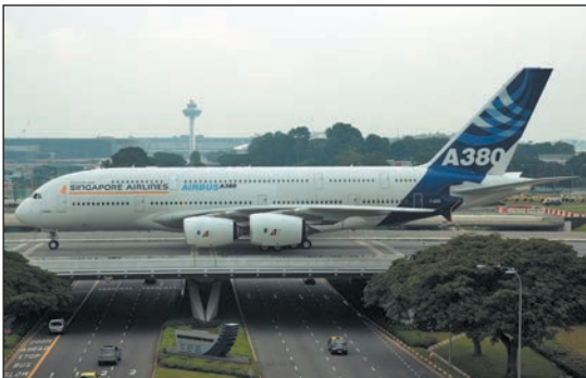
Мал. 4. Двопалубний реактивний пасажирський авіалайнер Аеробус А380 — найбільший серійний літак у світі (висота — 24,08 м, довжина — 72,75 м, розмах крила — 79,75 м). Він перевозить 525 пасажирів у салонах трьох класів або 853 в однокласовому варіанті. Може здійснювати безпосадочні перельоти на відстань понад 15 тис. км.
