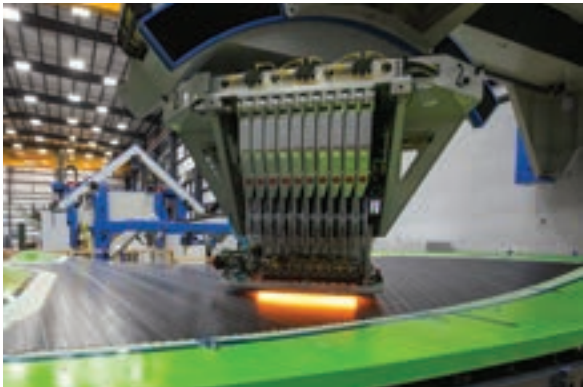
Рис. 1.10. Виготовлення крила Boeing
