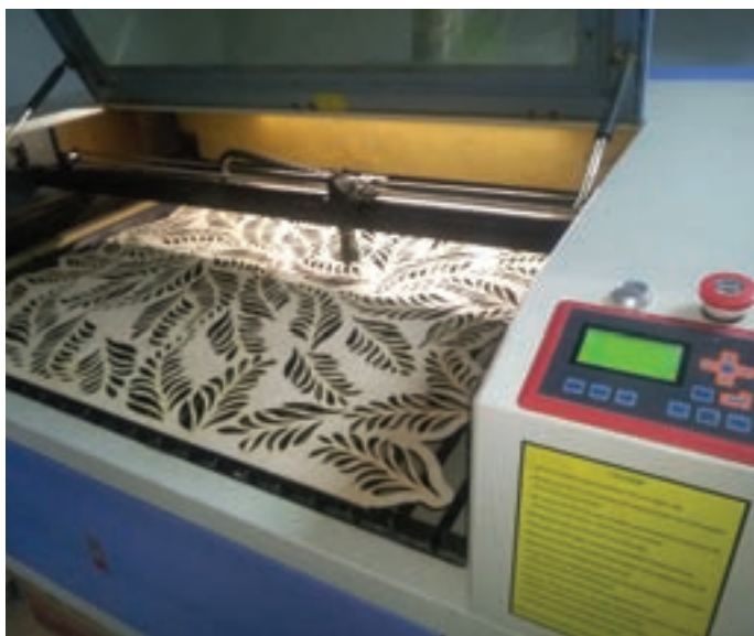
Рис. 5.3. На верстатах із ЧПК можна виготовляти вироби з оргскла, пластику, фанери і навіть із паперу
