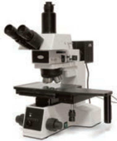
Рис. 7.4. Сучасний оптичний люмінесцентний тринокулярний мікроскоп
