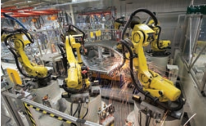
Рис. 8.3. Початкове зварювання деталей кузова Volkswagen Polo Sedan виконують вісім роботів
