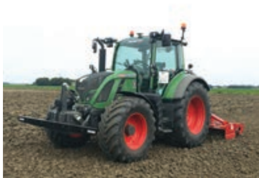
Рис. 8.11. Трактор Fendt, оснащений системою Probotiq, перетворюється на безпілотник
