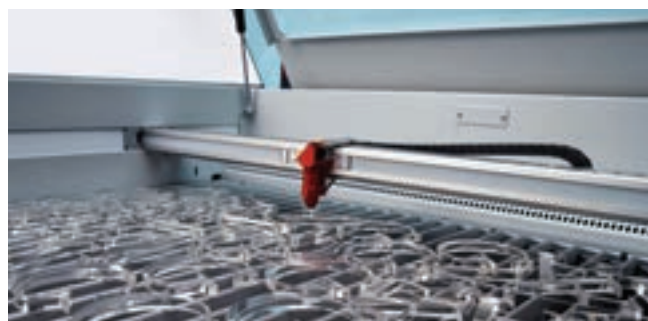
Рис. 5.5. Різання оргскла на верстатах із ЧПК
