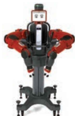
Рис. 8.6. Робот Baxter за допомогою двох маніпуляторів, кожен з яких має сім ступенів свободи, виконує типові операції
