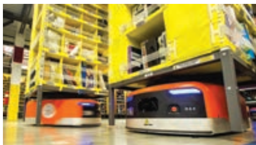
Рис. 8.9. Роботи Kiva на складах Amazon пересуваються зі швидкістю 7,5 км/год, можуть перевозити вантажі вагою 280 кг і в 4–5 разів ефективніші за працівників
