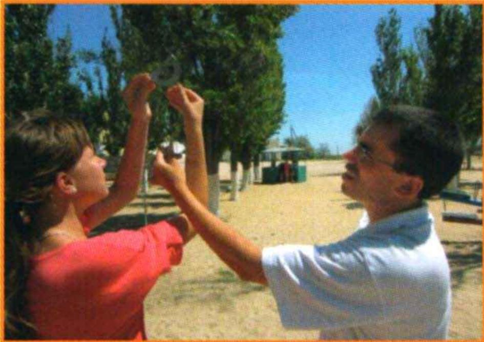
Щоб виміряти висоту Сонця над горизонтом, спрямуйте екліметр на Сонце так, щоб проміння проходило крізь отвори на загнутих краях екліметра. Нитка з тягарцем вкаже на шкалі кутову висоту Сонця над горизонтом.
