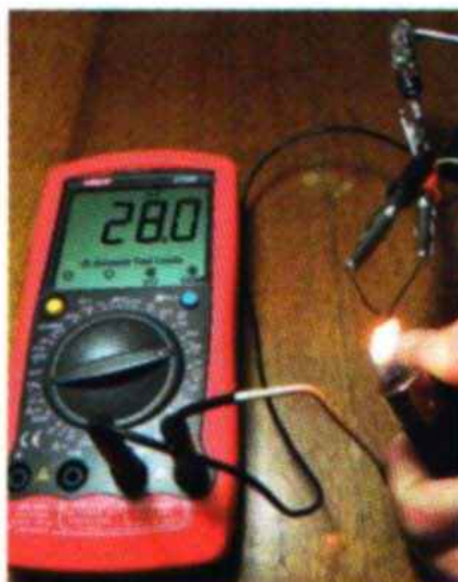
Мал. 8. Термопара – джерело струму
