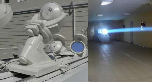
а б Мал. 1.3. Целостатна група (а) та об'єкти горизонтального сонячного телескопа (б) АЦУ-5 ГАО НАН України
