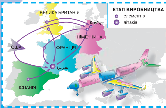
Мал. 26. Схема виробничої кооперації з виробництва літаків «Аеробус»
