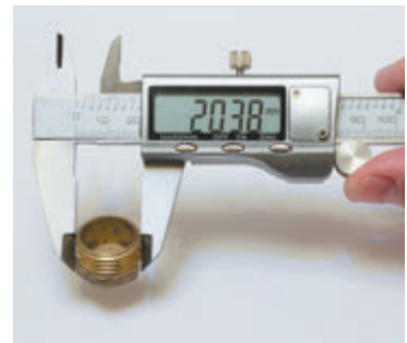
Fig. 2.3. Șubler. Precizia măsurătorii cu aparatul reprezentat — sutimi de milimetru
