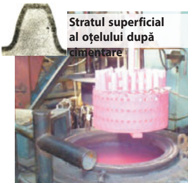
Fig. 27.4. Procesul de saturare a stratului superficial al oțelului cu carbon se numește cimentare . Dacă se va confecționa o piesă din oțel cu conținut scăzut de carbon, iar apoi ea se va pune într-un amestec cu temperatură înaltă, care conține carbon, atunci datorită difuziei stratul superficial din oțel va fi îmbogățit cu carbon. Piesa obținută va fi în același timp solidă (din exterior — fontă dură) și nu se va distruge în urma încărcăturilor de șoc (din interior — oțel elastic)
