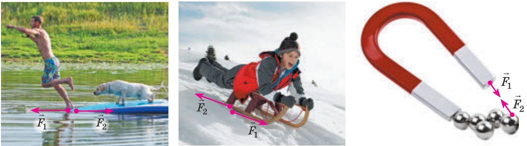
Fig. 10.4. Forțele, ce apar în timpul interacțiunii, au aceeași natură, sunt orientate în lungul unei drepte, sunt egale ca modul și opuse ca direcție
