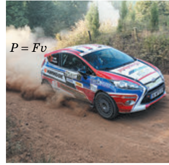
Fig. 15.3. Când pentru mișcarea automobilului este necesară o forță mai mare, șoferul trece la o viteză mai mică sau apasă pe accelerație, mărind astfel puterea motorului
