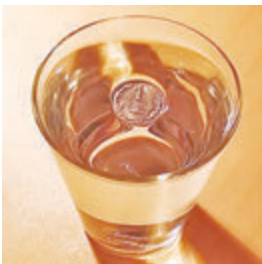
Fig. 33.4. Moneda se menține pe suprafața apei datorită forței de tensiune superficială (pentru a efectua așa o experiență, moneda trebuie ținută între degete și cu precauție lăsată pe suprafața apei).
