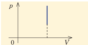
Fig. 37.5. În timpul procesului izocor gazul nu efectuează lucru
