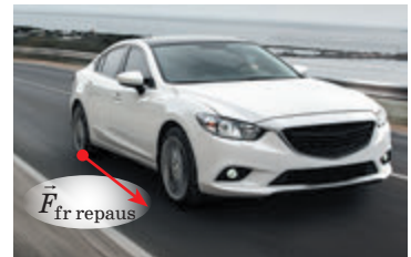
Fig. 13.5. Anvelopele automobilului în momentul atingerii cu suprafața drumului tind de fapt să efectueze mișcarea înapoi. Ca urmare apare forța de frecare de repaus, orientată înainte, — forță motoare
