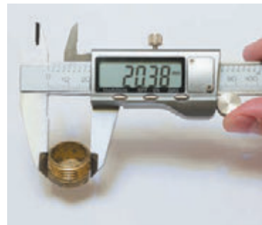
2.3. ábra. Tolmérc. Mérési pontossága a milliméter századrésze
