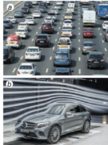
2.1. ábra. A gépkocsi sebességének és mozgásidejének a meghatározásához „anyagi pont” fizikai modellt használnak (a); az autó aerodinamikai tulajdonságainak tanulmányozására ez a fizikai modell nem alkalmazható (b)
