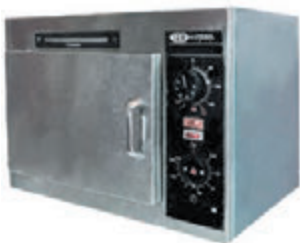
31.8. ábra. A vizet autoklávokban melegíthetik fel magas hőmérsékletre. 100 atm nyomásnál a víz forráspontja 300 °C lesz
