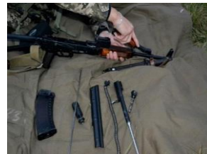
Іл. 19.10. Відокремлення газової трубки
