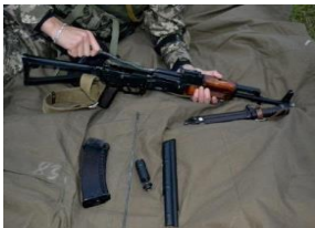
Іл. 19.7. Відокремлення зворотного механізму
