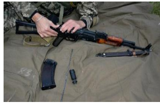
Іл. 19.6. Відокремлення кришки ствольної коробки
