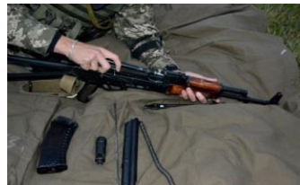
Іл. 19.8. Відокремлення затворної рами із затвором
