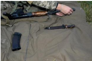
Іл. 19.5. Відокремлення дульного гальма-компенсатора
