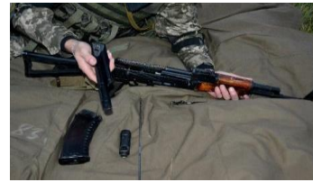
Іл. 19.6. Відокремлення кришки ствольної коробки
