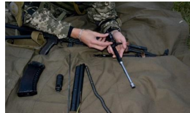
Іл. 19.9. Відокремлення затвора від затворної рами
