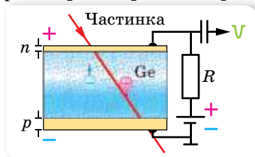
Мал. 249. Схема напівпровідникового лічильника
