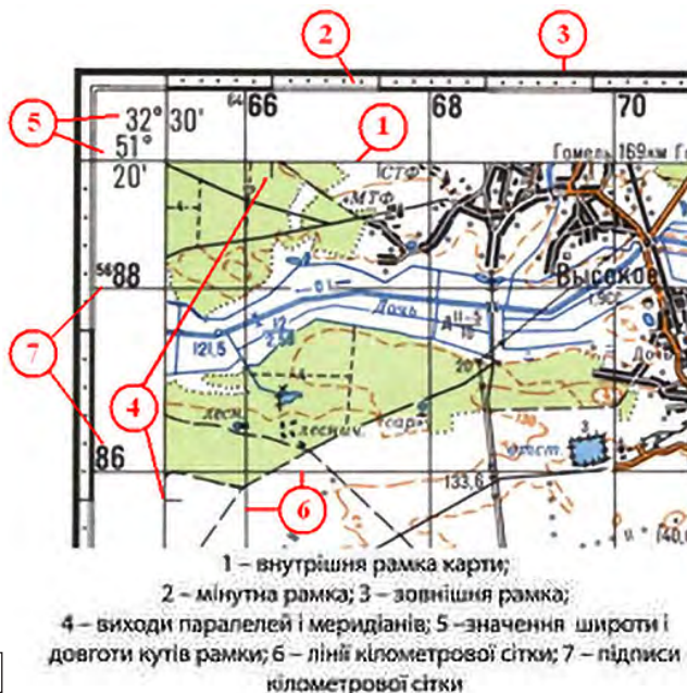
Мал. 3. а) Рамка і кілометрова сітка топографічної карти (1:100 000); б) зразок визначення географічних і прямокутних координат точок за картою.
