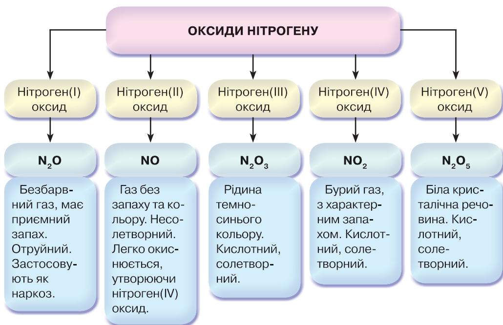
Рис. 37. Схема класифікації оксидів Нітрогену
