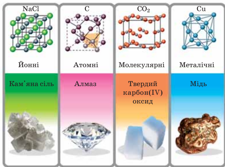
Мал. 15 Моделі кристалічних ґраток і приклади речовин з різними типами кристалічних ґраток
