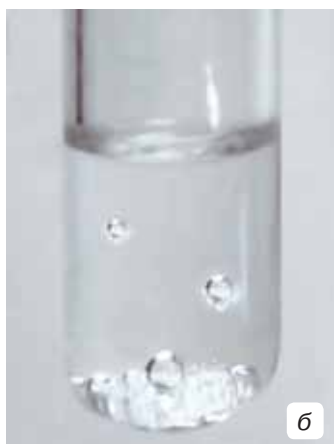
Мал. 52 Взаємодія алюмінію з кислотами: а — хлоридною; б — сульфатною
