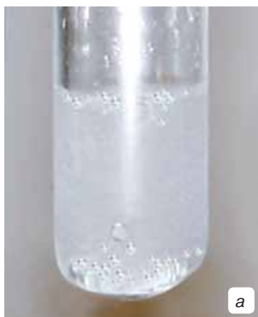
Мал. 52 Взаємодія алюмінію з кислотами: а — хлоридною; б — сульфатною
