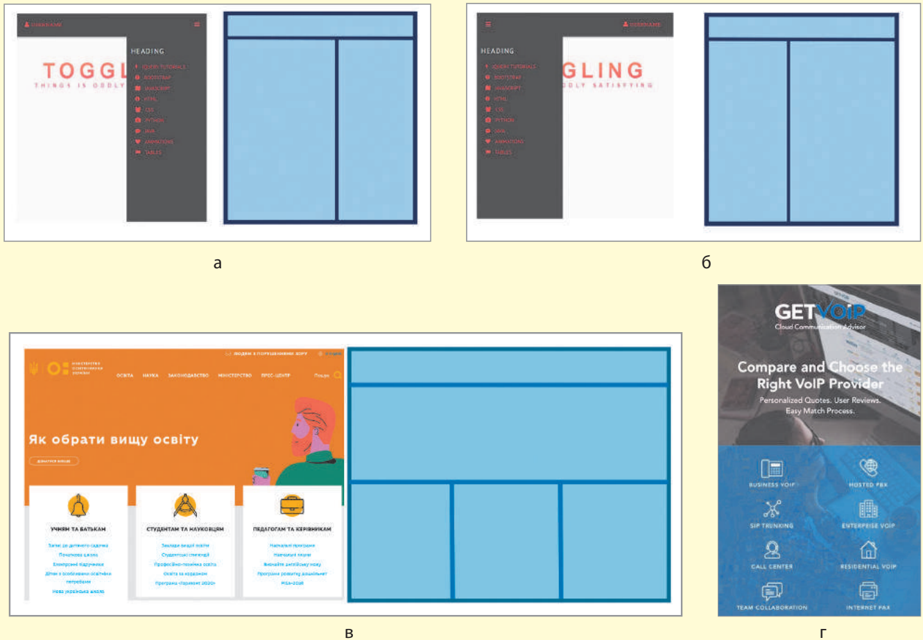
Рис. 11.50. Приклади сайта: з навігацією в лівому стовпці (а); навігацією в правому стовпці (б); горизонтальною навігацією (в); технологією Mobile First (г)
