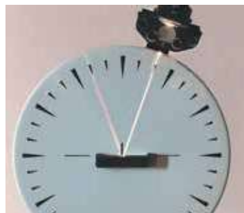
Fig. 25.3. Odată cu schimbarea unghiului de incidență al luminii variază și unghiul de reflexie al ei. Unghiul de reflexie de fiecare dată este egal cu unghiul de incidență
