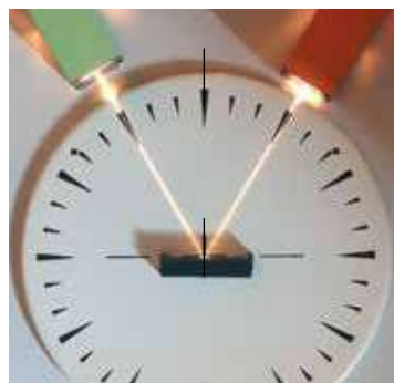
Fig. 25.4. Demonstrarea reversibilității razelor de lumină: raza reflectată merge pe calea razei incidente
