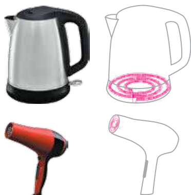
Fig. 3.3. Partea principală a oricărui aparat de încălzire — elementul încălzitor, care reprezintă în sine un conductor confecționat din material greu fuzibil cu o rezistență specifică mare, ce are o arie a secțiunii transversale mică (în comparație cu conductoarele de conexiune)
