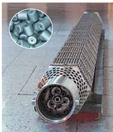
Fig. 42.4. EExTc (element exotermic) – dispozitiv, în care se conține combustibilul nuclear (pastile de dioxid de uraniu (IV), îmbogățit cu izotopul {}^{235}_{92}\text{U} )
