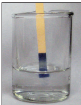
Fig. 16. Colorarea indicatorului universal în soluția apoasă de carbonat de sodiu
