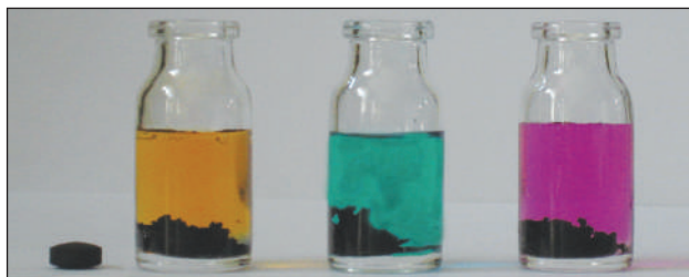
Fig. 34. Începutul experienței cu determinarea proprietăților adsorbice ale cărbunelui activat
