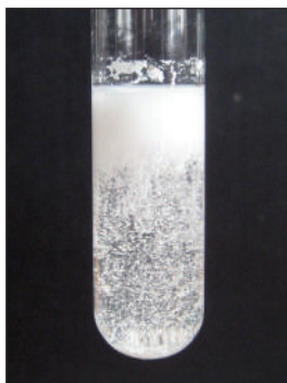
Fig. 89. Sedimentul clorura de argint
