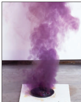
Fig. 64. Reacția dintre aluminiu și iod
