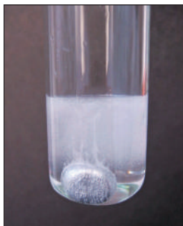
65. ábra Alumínium reak- ciója lúggoldattal
