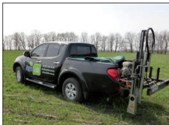
94. ábra Vegyitalajelemező az autó platóján
