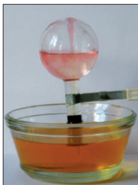
42. ábra A hidrogén-klorid oldódása vízben (szökőkút-kísélet)
