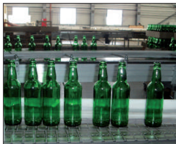
85. ábra Szállítószalag az üvegyárban
