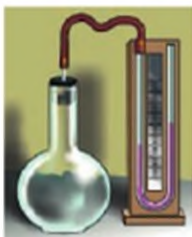
Мал. 29.2. Відкритий рідинний манометр.
