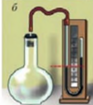
Мал. 29.3. Закритий манометр міряє малі тиски.
