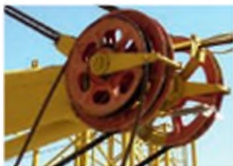
Мал. 36.2. Блок зм'якшує напрям дії сили
