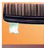
Мал. 3.1. Наелектризований гребінець притягує дрібні предмети.
