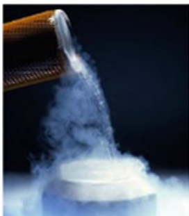
Мал. 4.6. Рідкий азот кипить при -196^{\circ}\text{C} .
