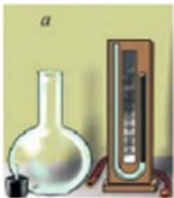
Мал. 29.2. Відкритий рідинний манометр.
