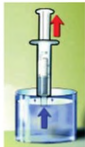
Мал. 29.4. Вода слідує за поршнем насоса, бо її туди «втискає» сила атмосферного тиску.
