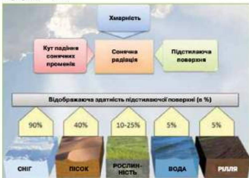
Мал. 16. Здатність різних поверхонь відбивати сонячну радіацію
