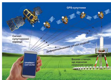
Схема триангуляції у GPS-навігації
