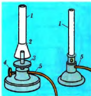
Мал. 23. Газові пальники: 1 — трубка; 2 — змішувач; 3 — диск; 4 — гвинт; 5 — відвідна труба
