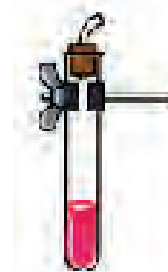
Мал. 15. Так треба закріплювати пробірку в штативі
