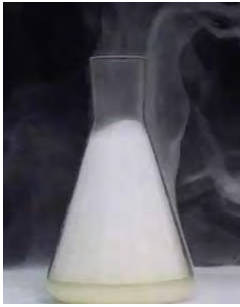
Мал. 75. Вбирання теплоти під час розчинення \text{NH}_4\text{NO}_3 у воді
