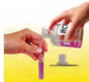
Мал. 9. Так потрібно брати банку з реактивом, щоб етикетка спрямовувалась у бік долоні
