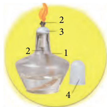
Мал. 16. Спиртівка: 1 — резервуар зі спиртом; 2 — гніт; 3 — металічна трубка з диском; 4 — ковпачок
