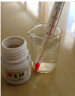
Мал. 76. Виділення теплоти під час розчинення \text{H}_2\text{SO}_4 у воді
