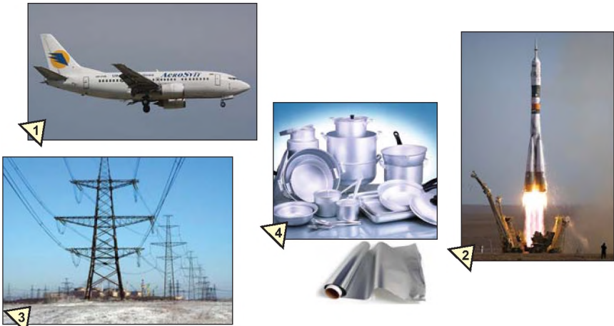
Мал. 46. Застосування алюмінію: 1 — літакобудування; 2 — ракетобудування; 3 — спорудження ліній електропередач; 4 — виробництво кухонного посуду та пакувальної фольги
