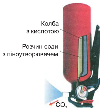
Мал. 72. Кислотний вогнегасник у дії
