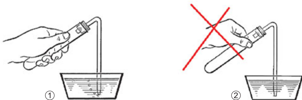
Рис. 1. Перевірка приладу для добування газів на герметичність. 1. Правильно. 2. Неправильно
