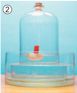
Рис. 17.3. Визначення об'ємної частки кисню в повітрі
