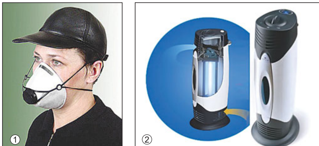
Рис. 24.1. 1. Респіратор – індивідуальний засіб захисту органів дихання від пилу. 2. У промислових і побутових фотокаталітичних очищувачах повітря забруднювачі не накопичуються, а окиснюються до нешкідливих речовин. Схема роботи: забір повітря з приміщення (1); на фотокаталітичному фільтрі ( \text{TiO}_2 ) органічні забруднювачі повітря окиснюються до вуглекислого газу і води (2); УФ – лампа дезінфікує повітря (3); очищене повітря надходить до приміщення (4)
