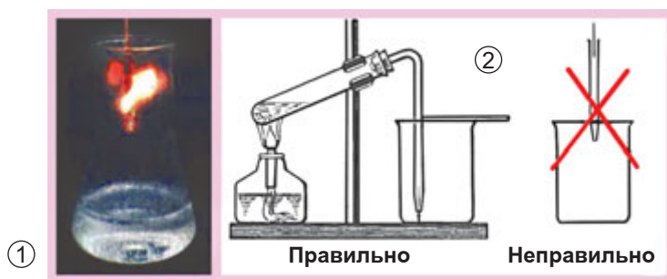
Рис. 20.1. Добування кисню термічним розкладанням гідроген пероксиду (1) і схема збирання газу витісненням повітря (2)
