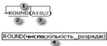
Рис.4.23. Структура опису функції, яка здійснює округлення значень 1 — структура звернення (виклику) функції; 2 — ім'я функції; 3 — аргументи; 4 — підказка синтаксису.
