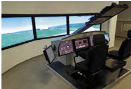
Рис. 2.3. Авіаційний тренажер – модель кабіни літака
