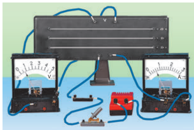
Рис. 30.2. Дослід, який доводить, що опір провідника обернено пропорційний площі його поперечного перерізу
