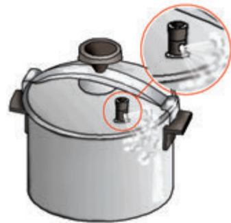
Рис. 14.5. Кастрюля-скороварка: завдяки клапанам і герметичній кришці підтримується високий тиск у просторі над рідиною, тому температура кипіння води в такій кастрюлі становить близько 120\text{ }^{\circ}\text{C}
