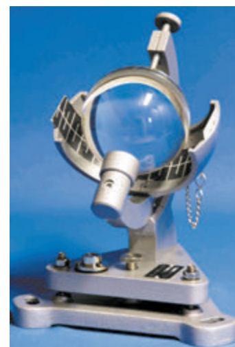
Мал. 18.2. Геліограф — прилад для визначення тривалості сонячного сяйва. Скляна лінза концентрує сонячні промені й пропалює стрічку, поділену на годинні відрізки
