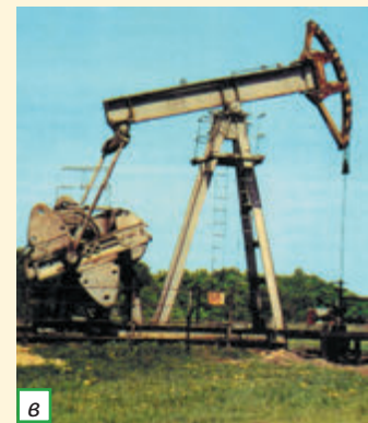
Мал. 15.3. Нафтова вишка в Дніпровсько-Донецькій западині (а), бурова платформа на Чорному морі (б), нафтовий верстат-качалка (в)
