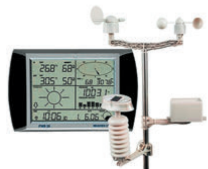
Мал. 21.5. Сучасна побутова автоматична метеостанція
