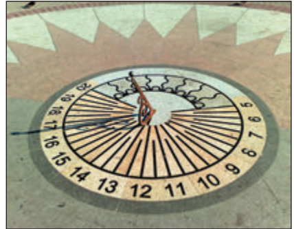
Мал. 1. Соляний годинник. Зміна довжини тіні гномона (це може бути вертикальна жердина) вказує час доби вдень.
