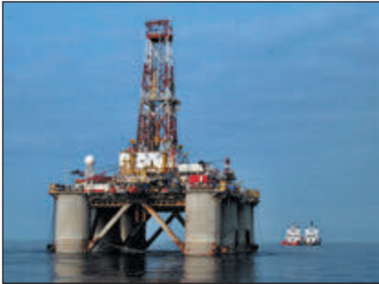
Мал. 2. Голіцинське родовище. Бурова установка на морській стаціонарній платформі на шельфі Чорного моря.
