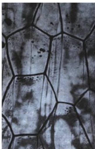
Мал. 22. Лід під мікроскопом. Видно обриси окремих кристалів, що мають форму шестигранників. Чорні точки на фотографії — це бульбашки повітря і тала вода
