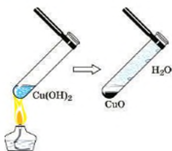
Мал. 48. Розкладання купрум(II) гідроксиду під час нагрівання
