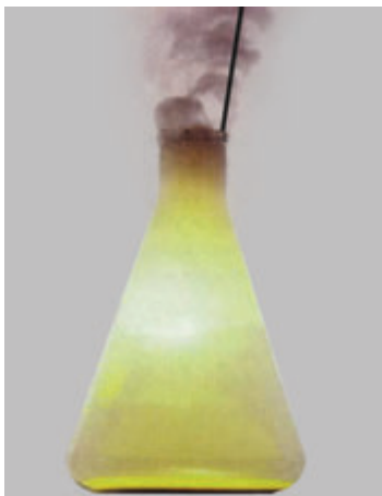
Мал. 41.1. Взаємодія натрію з газуватим хлором з утворенням натрій хлориду
