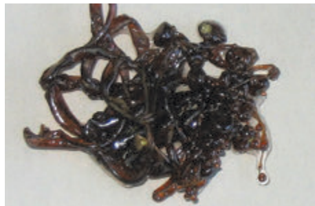
Мал. 23.2. а — кристалічна сірка; б — аморфна пластична сірка
