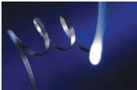
Мал. 40.1. Під час горіння магнієвої стрічки утворюється магній оксид із виділенням великої кількості світла
