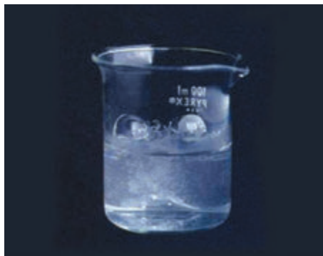
Мал. 36.6. За кімнатної температури магній взаємодіє з водою дуже повільно, розчин дещо мутніє внаслідок утворення малорозчинного магній гідроксиду
