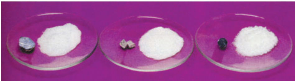
Мал. 15.3. Лужні метали — літій, натрій, калій (зображені ліворуч на кожному склі) — складаються з атомів відповідних металічних елементів і є м'якими та блискучими речовинами з високою реакційною здатністю. Йони цих лужних елементів, що містяться у складі хлоридів (зображені праворуч), є хімічно інертними
