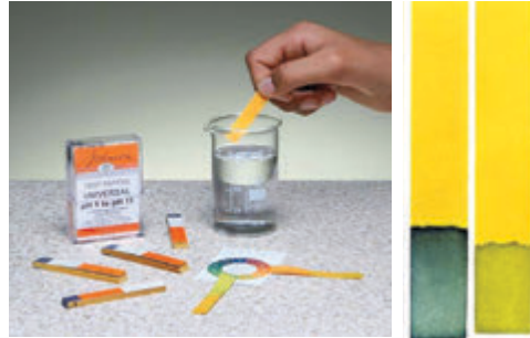
Мал. 33.4. Універсальний індикатор може не тільки виявляти кислоти або основи, але й визначати їхні концентрації
