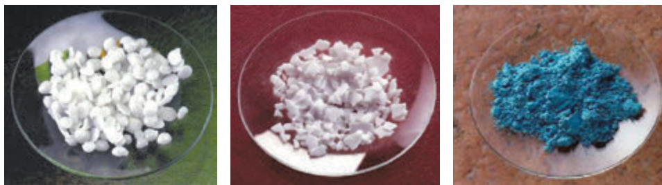
Мал. 32.1. Основи: а — натрій гідроксид являє собою білі гранули; б — калій гідроксид — білі лусочки; в — купрум(II) гідроксид — синій порошок
