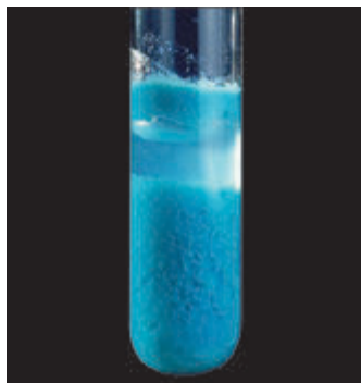
Мал. 38.1. Про реакцію купрум(II) хлориду та лугу свідчить утворення синього осаду купрум(II) гідроксиду
