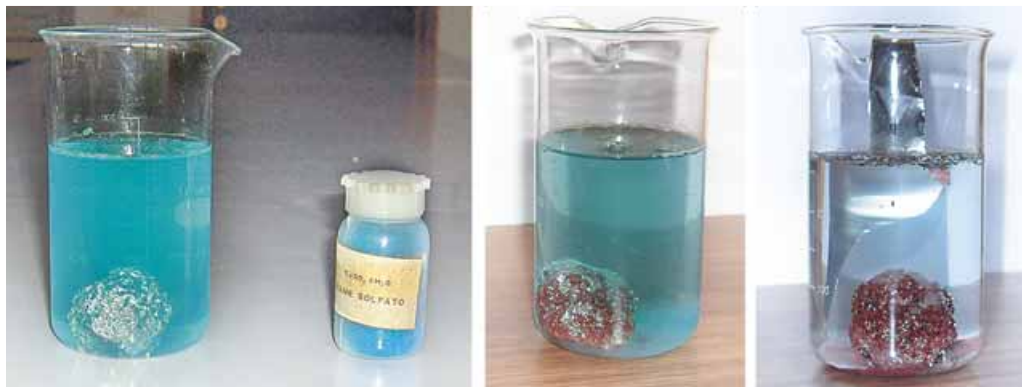
Рис. 31.3. Алюмінієва фольга поступово вкривається шаром міді. Розчин знебарвлюється – адже другим продуктом реакції є безбарвний алюміній сульфат
