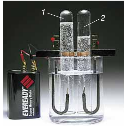
Рис. 21.3. Розкладання води електричним струмом
