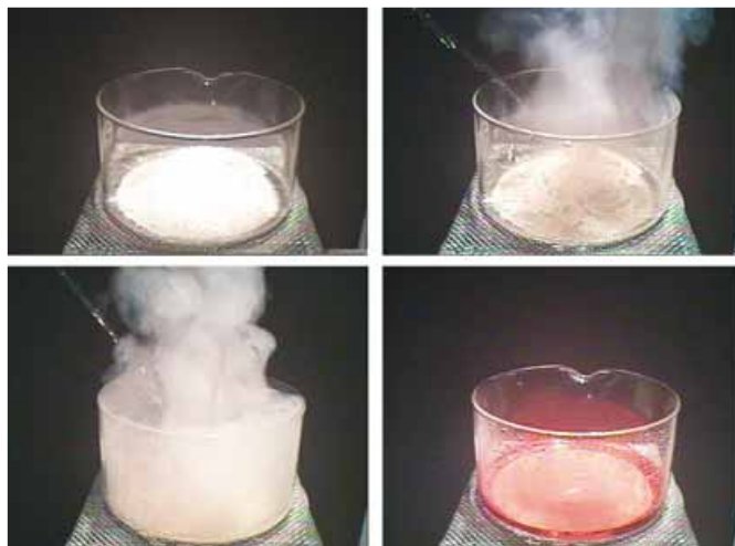
Рис. 23.5. Фосфор(V) оксид бурхливо реагує з водою. Метилевий оранжевий набув у водному розчині продукту реакції рожевого кольору
