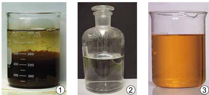
Рис. 26.1. Розчинення осаду ферум(III) гідроксиду (1) під дією хлоридної кислоти (2) з утворенням прозорого бурого розчину ферум(III) хлориду (3)
