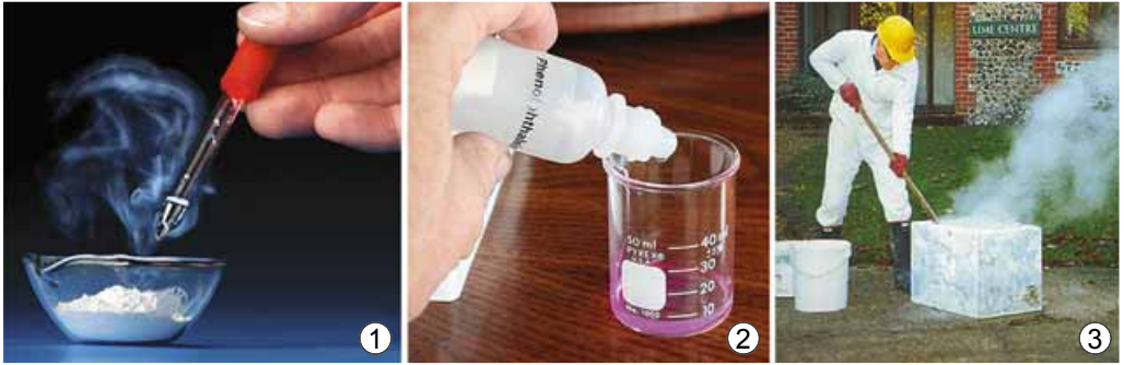
Рис. 23.2. 1. Реакція кальцій оксиду з водою. 2. Виявлення луку за допомогою розчину фенолфталеїну. 3. Гасіння вапна
