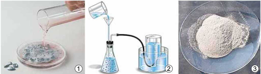
Рис. 28.2. 1. Взаємодія цинку з хлоридною кислотою. Продукти реакції: 2 – газуватий водень можна зібрати витісненням води; 3 – цинк хлорид кристалізується з розчину за нагрівання
