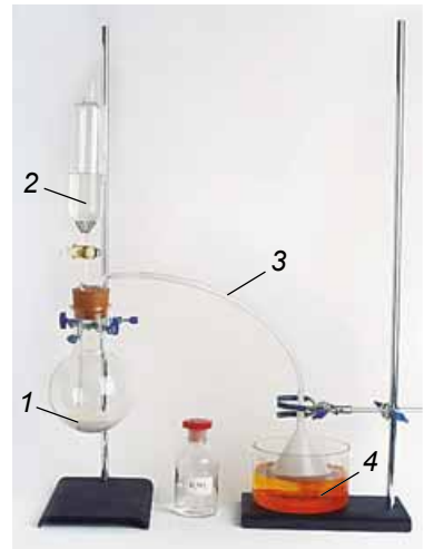
Рис. 29.5. Добування хлороводню й розчинення цього газу у воді.
