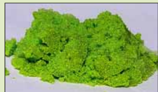
Рис. 28.3. Взаємодія заліза з хлоридною кислотою. Продукти реакції – водень (безбарвний газ) та ферум(II) хлорид – речовина зеленого кольору
