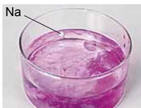
Рис. 4.4. Реакція натрію з водою, до якої додано індикатор фенолфталеїн. Завдання. Поміркуйте, чому фенолфталеїн набуває малинового кольору в розчині, що утворюється внаслідок реакції натрію з водою. Перетворіть схему реакції натрію з водою на хімічне рівняння
