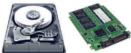
Рис. 7.6. Жорсткі диски HDD та SSD
