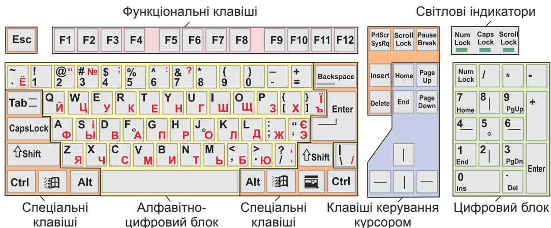
Рис. 8.1. Клавіатура з відповідними клавішами
