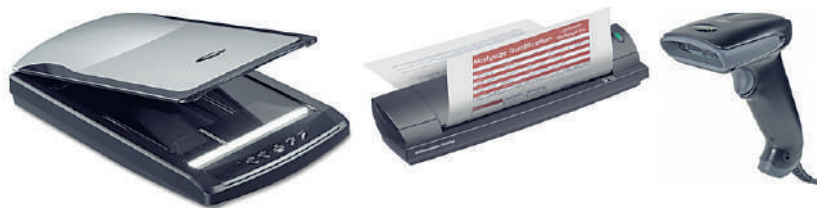
Рис. 8.2. Планшетний, листовий (протяжний), ручний сканери
