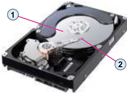
Мал. 2.6. Будова накопичувача на жорстких магнітних дисках
