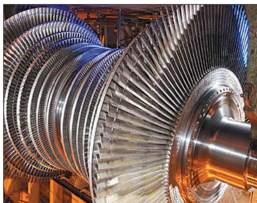
Рис. 17.2. У сучасних турбінах для максимального використання енергії пари застосовують кілька дисків з лопатями, які насажено на один спільний вал
