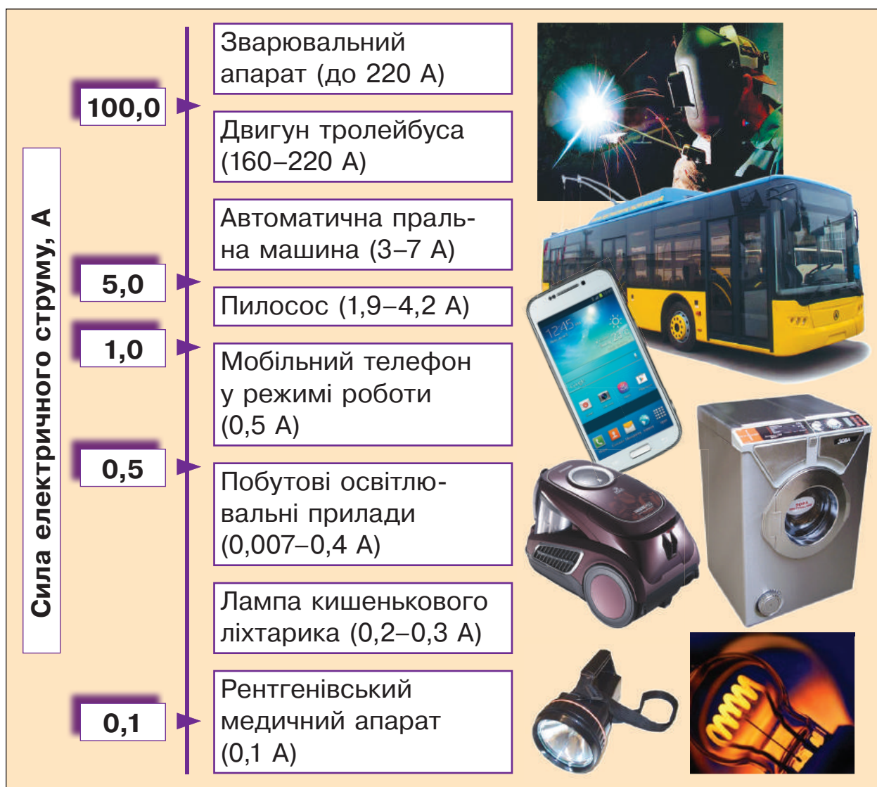
Рис. 27.4. Значення сили струму в деяких пристроях
