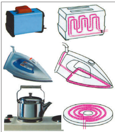
Рис. 35.2. Основна частина будь-якого електричного нагрівального пристрою — нагрівальний елемент
