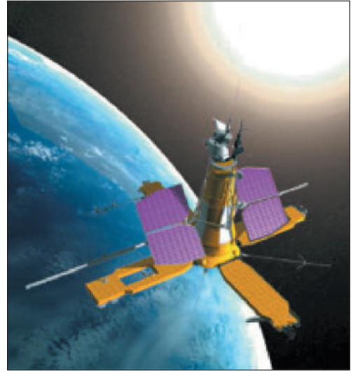
Рис. 25.3. Сонячні батареї супутника Землі постачають електроенергію для всієї дослідницької апаратури.
