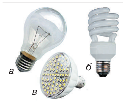
Рис. 24.3. Електричні лампи — пристрої, в яких електрична енергія частково перетворюється на енергію світла: а — лампа розжарення (ККД — 5 %); б — люмінесцентна лампа (ККД — 10–20 %); в — світлодіодна лампа (ККД — 50 %)
