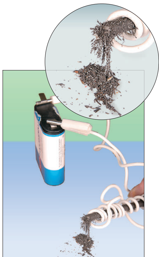
Рис. 24.5. Під час пропускання струму цвях стає магнітом і притягує до себе залізні ошурки
