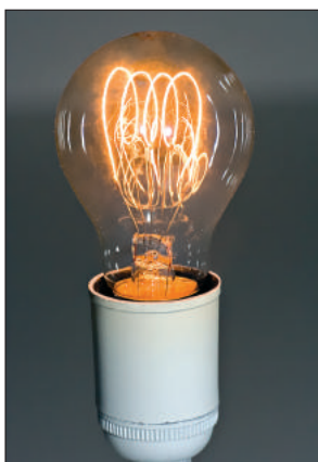
Рис. 35.3. Нагрівальний елемент лампи розжарення виготовляють із вольфраму (температура плавлення 3387^{\circ}\text{C} ). Нагріваючись до температури 3000^{\circ}\text{C} , тонка вольфрамова нитка яскраво світиться
