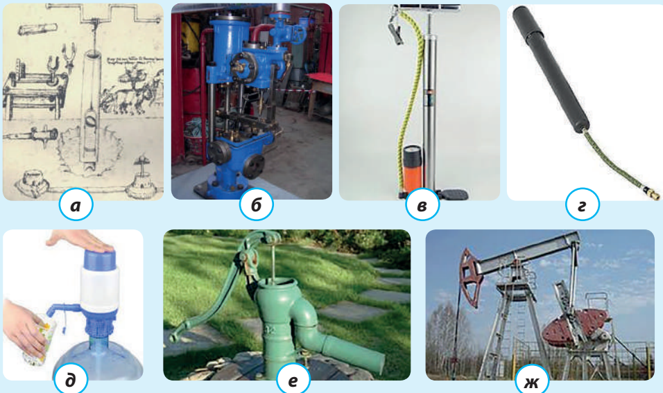
Мал. 26. Приклади насосів: а — зображення поршневого насоса, приблизно 1450 рік; б — насос водозливу; в — ручний автомобільний насос; г — велосипедний насос; д — помпа для води; е — колонка; ж — насос для викачування нафти
