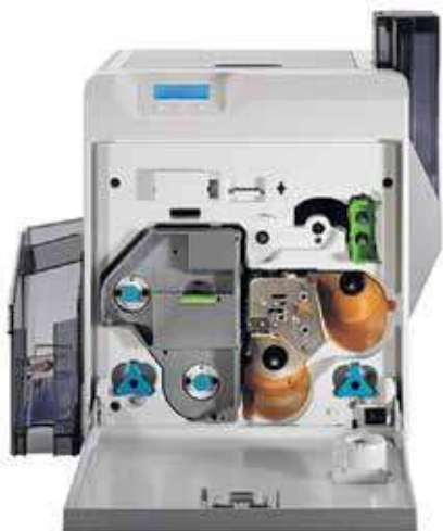
Fig. 2.32. Imprimantă cu sublimare și un set de pelicule colorate pentru el
