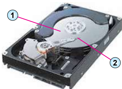
Fig. 2.6. Construcția stocatorului cu discuri magnetice rigide
