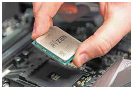
Fig. 2.2. Procesorul AMD Ryzen 7 cu 8 nuclee
