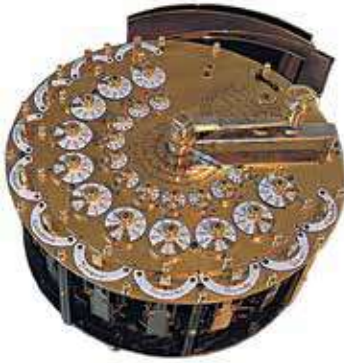
Fig. 2.49. Mașinuta pentru calculare a lui I. G. Muller
