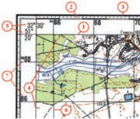
19. ábra. A topográfiai térkép (1 : 100 000) keretei és kilométerhálója: 1 — belső keret; 2 — percek kerete; 3 — külső keret; 4 — szélességi körök és délkörök kimenete; 5 — a keret szélességi és hosszúsági szögeinek számértéke; 6 — a kilométerháló vonalai; 7 — a kilométerháló számértékei
