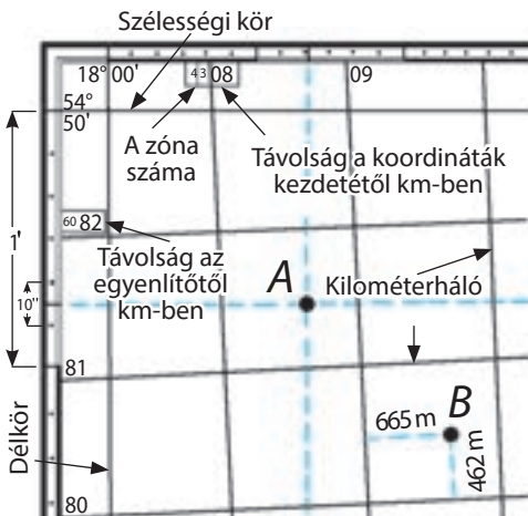
19. ábra. A topográfiai térkép (1 : 100 000) keretei és kilométerhálója: 1 — belső keret; 2 — percek kerete; 3 — külső keret; 4 — szélességi körök és délkörök kimenete; 5 — a keret szélességi és hosszúsági szögeinek számértéke; 6 — a kilométerháló vonalai; 7 — a kilométerháló számértékei
