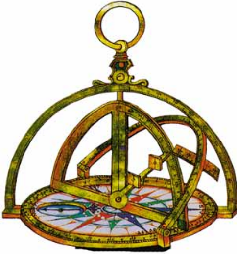
Морська напівсфера – прилад, який дозволяв точно тримати обраний курс корабля
