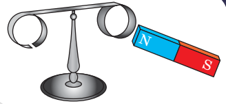
Мал. 68. Пристрій для виявлення індукційного струму
